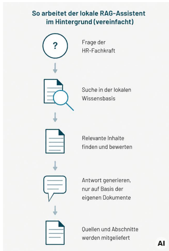
Abbildung 1: Ablauf der Funktionsweise eines HR-RAG
